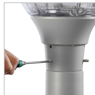
HapiLED umožňuje uchycení na sloup o průměru 60mm pomocí šesti šroubů M6
