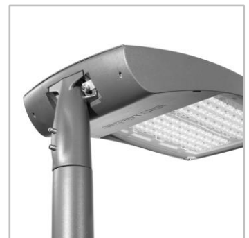
Svítilna řady TECEO GEN2 nabízejí univerzální způsob uchycení pro čepy od Ø32 do Ø76 mm a trubku o průměru Ø60 mm.
