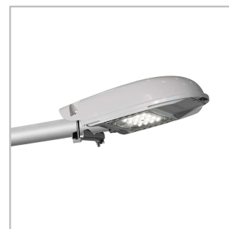
Přesné nastavení na místě. Úhel sklonu lze nastavit od -15° do +5° pro montáž na bočníci a od -10° do +10° s adaptérem pro horní uchycení.
